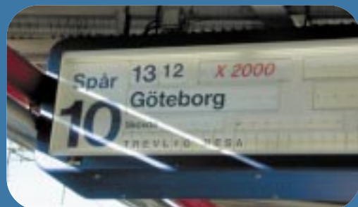
▲ ▼ TIDSUPPLYSNING + SKYLTY. EBICOS 900 matar också ut data till upplysningskärmar för resenärerna och skyltarna på plattformarna, via systemet Tetras. Det är dessutom trafikledarnas uppgift att göra högtalarutropen på stationerna inom distriktet. Det finns bildskärmsystem av flera årsmodeller för pendeltåg och fjärrtåg, helgrafiska såväl som alfanumeriska. Den allra senaste syns lite i bakgrunden, har orange bakgrund och gäller för Arlandabanan.
