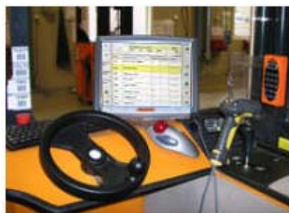
Figur 15 En bildskärm från Åkerströms installerad inuti en truck. Bilden är ett montage.
